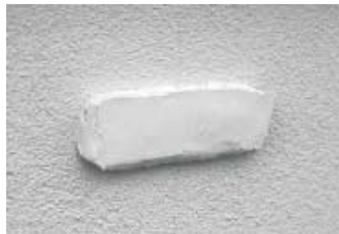
Abb.: Zu dicke Gipsmarke, dadurch Haftprobleme
