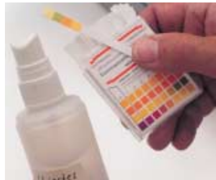
Abb.: Prüfen der Alkalität. Wichtig ist das Anfeuchten mit destilliertem Wasser
