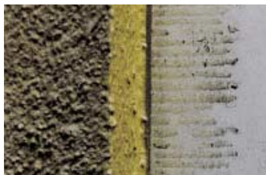
Abb.: Klebmasserückstände - Klebeband abgezogen bei Minustemperaturen
