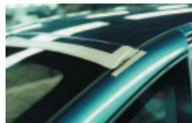
Fixierung von Autoscheiben gegen Verrutschen während der Montage
