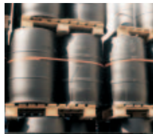
Transportsicherung schwerer Behälter gegen Verrutschen und Kippen
