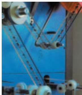
Sicherheit bei hohem Tempo: Gurten von elektronischen Bauteilen zur optimalen Sortierung und Darreichungsform
