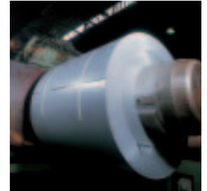
Transportschutz für höchste Ansprüche: Spezial-Klebmassen und glasfaserverstärkte Trägermaterialien sorgen für maximale Belastbarkeit, z.B. bei der Coil-Endverklebung
