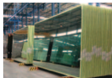
Kantenschutz an Fensterverglasungen während der Lagerung und auf dem Transportweg
